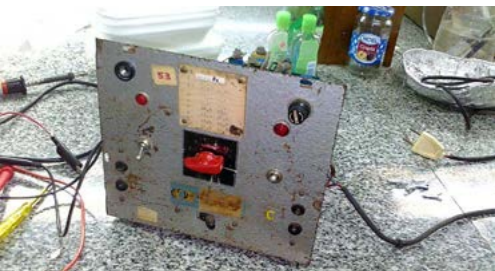
Lamentable estado de la fuente de alimentación 1,5 a 14 V fuera de uso y a punto de darse de baja.
