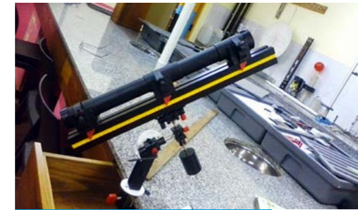
Montaje del ecuatorial con telescopio astronómico bim.
