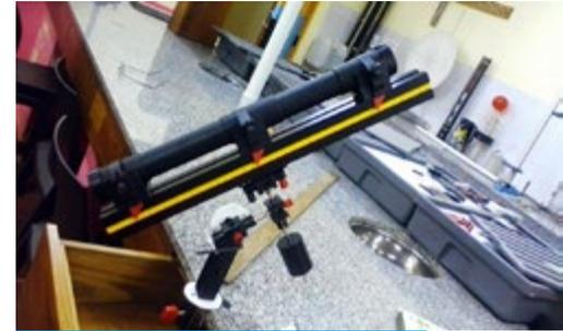
Montaje del ecuatorial con telescopio astronómico bim.
