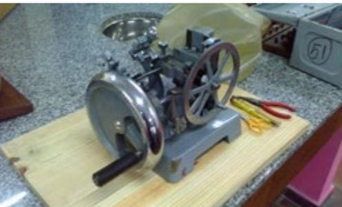
Micrótopo reparado. Con la lupa se verificó cada uno de los 520 dientes de engranaje para determinar si hubo daño por mal uso.
